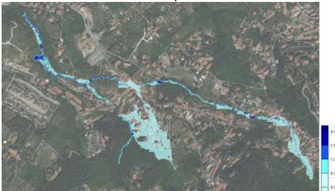
Per la parte a valle della confluenza con il Botro Stringaio –Botro ai Fichi è stata effettuata una seconda simulazione su griglia di 1.5x1 km con celle di passo 2x2 m, al fine di massimizzare le esondazioni nel tratto terminale.
