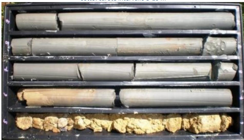
Fig. 22 Carote di sondaggio/piezometro loc. piscina Camalich/Neri - Livorno (Perizia idrogeologica Dr. Luca Mazzei)
